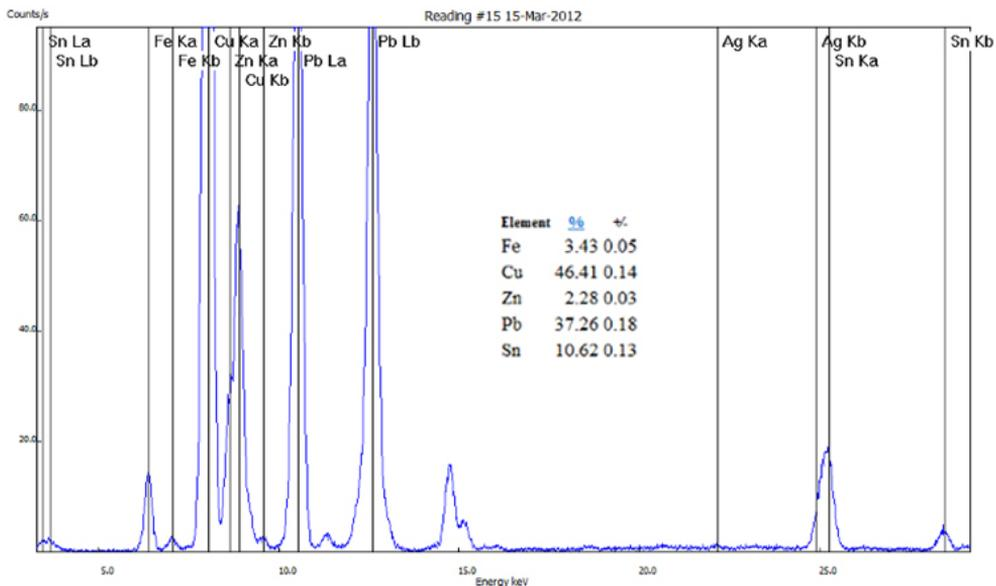
Fig. 11. XRF spectrum of the pendant
